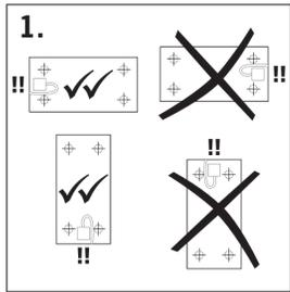
Es ist sehr wichtig, dass die Kabelbox auf der korrekten Seite ist – bitte die eingezeichnete Position horizontal als auch vertikal beachten. Mit Montageschablone die Position der Heizung festlegen und mit Wasserwaage ausrichten. Die Schutzfolie der Klebepunkte auf der Rückseite der Schablone entfernen. Schablone auf die Wand kleben.
