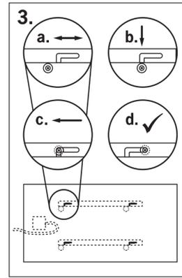
Vertikal: Die Box mit dem elektrischen Anschluss muss unten sein. Die Leisten auf der Rückseite rechts an die Knöpfe legen. Verschieben Sie die Heizung bis alle 4 Knöpfe in die Öffnungen der Leiste nach unten einrasten. Die Heizung dann noch leicht nach unten drücken bis sie in den Fräsungen arretiert ist.
